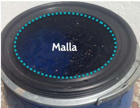
Filtro de hojas como tapa de un primer separador de tanbo
